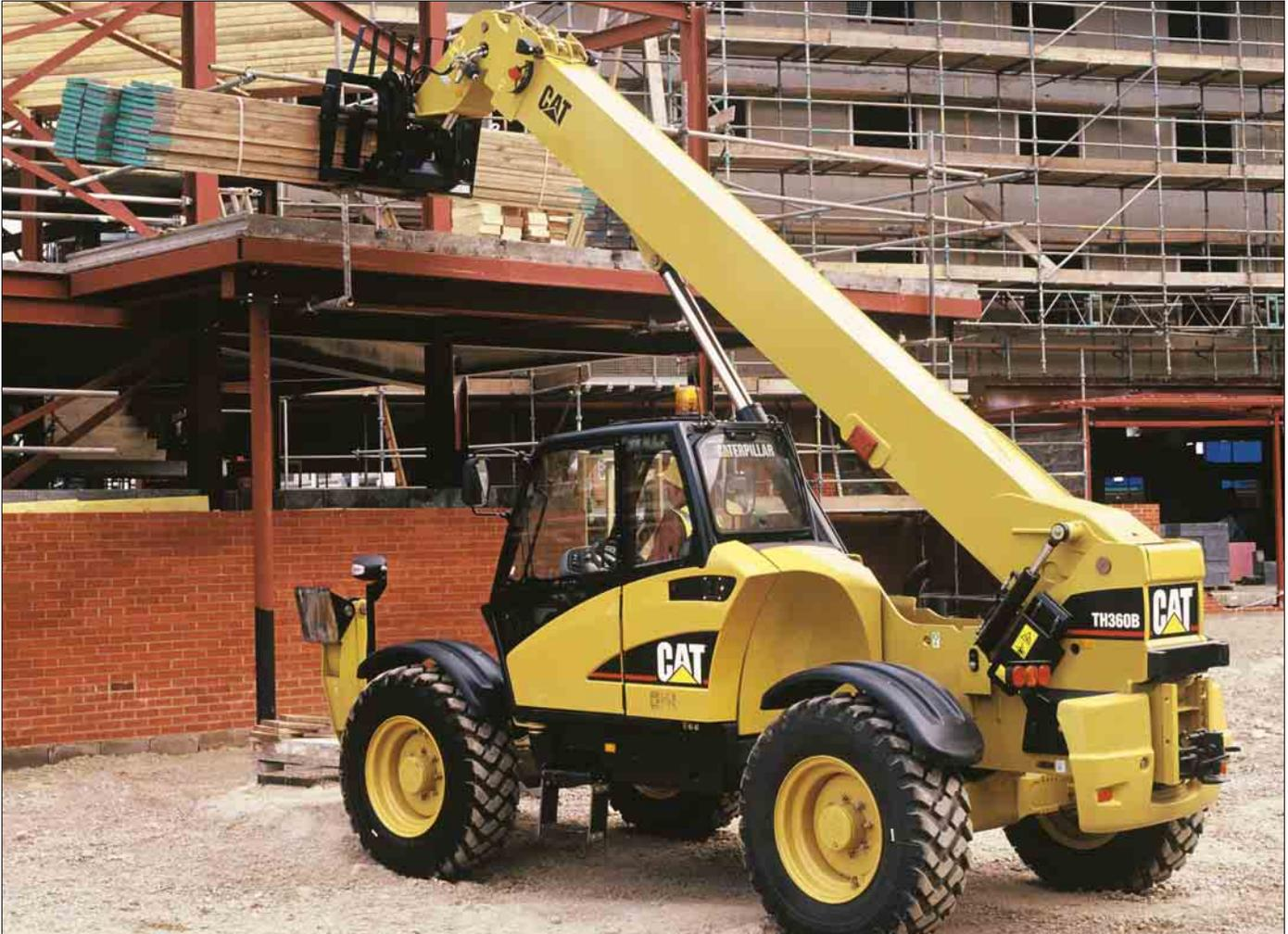
**Altezza di sollevamento.** Il TH360B può posizionare con facilità ogni tipo di materiale fino ad un'altezza massima di 13 500 mm.
