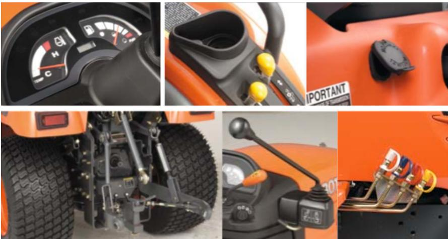
Attacco a 3 punti, con una capacità di 550 kg di palla è lo standard, quindi è possibile utilizzare una vasta gamma di accessori. Se si utilizzano accessori come una spazzatrice frontale o spazzaneve, il sollevatore anteriore e presa di corrente anteriore sono opzioni da prendere. Numerosi accessori possono essere utilizzati anteriore e una cabina opzionale è disponibile per il lavoro invernale, dando più confort.
